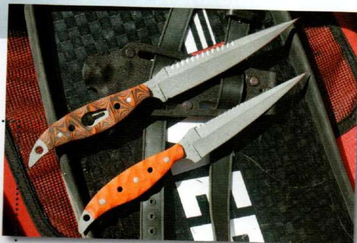
**Le poignard «Poséidon»** pour les plongeurs démineurs de la marine de Brest : 453 gr, longueur totale : 30 cm et tranchant de 16 cm, tranchant à dents de 9,5 cm, lame large de 4 cm et épaisse de 5 mm.
